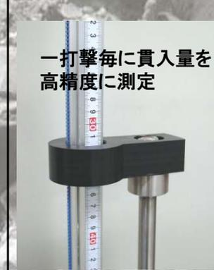
※データロガーを利用すると一打撃毎の貫入量を高精度で自動記録が可能
